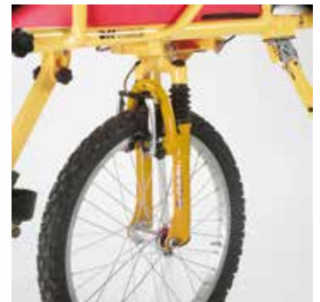
Forcella ammortizzata e freno di servizio. Fork with shock absorber and service brake.
